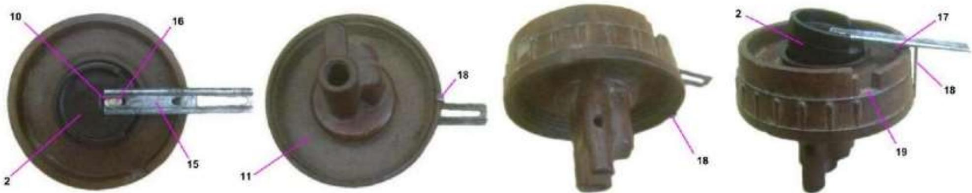
2 Druckdeckel 10 Auslösehebel 11 Zünderoberteil 15 Sicherungsblech 16 Steg 17 kurze Zunge 18 lange Zunge 19 Nut
